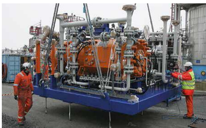
Рис.4- Подводный перекачивающий комплекс
